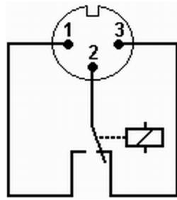
Abb. 13: Flanschstecker (Front) im Störungszustand
