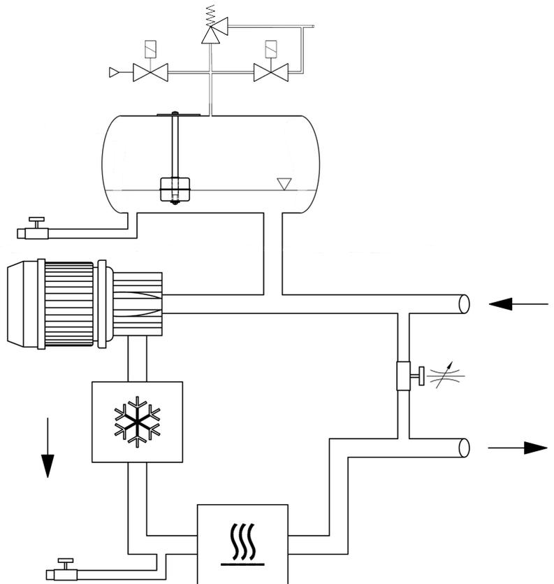
Abb. 8: Schema des Hydraulikkreislaufs bei Geräten IN P
