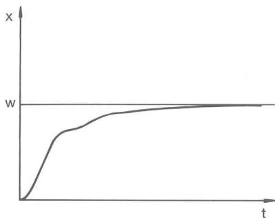
Abb. 77: Regelparameter  $T_n$  und  $T_v$  zu groß
