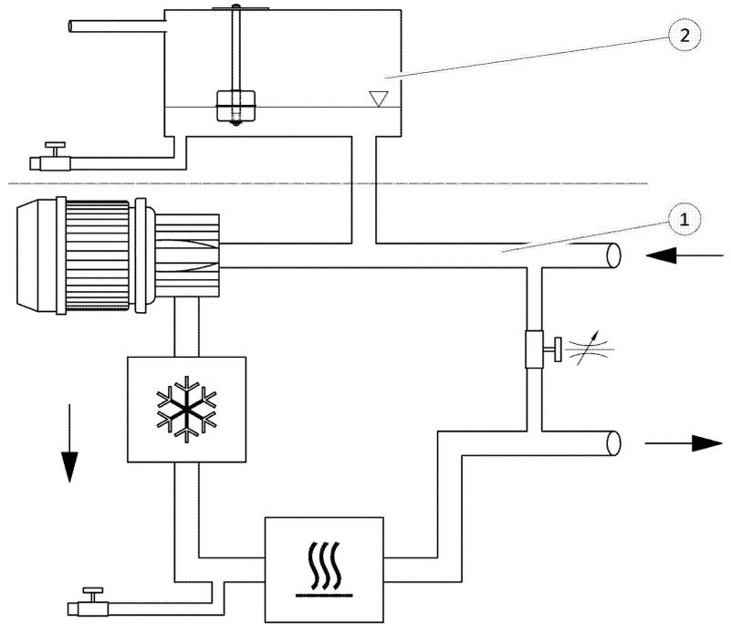
Abb. 7: Schema des Hydraulikkreislaufs bei Geräten IN XT
