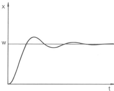
Abb. 76: Regelparameter  $T_n$  und  $T_v$  zu klein
