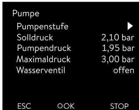
Abb. 29: Menü Pumpe bei Integral IN XT
